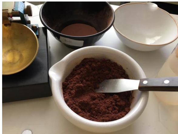
Figura 2 – Ensaio de Limite Liquidez em andamento
