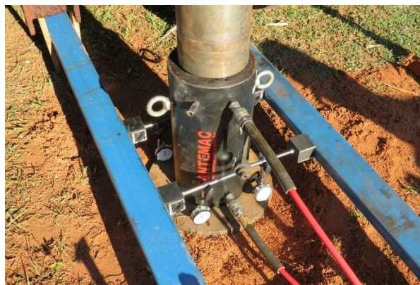
Figura 2 - Sistema de aplicação de carga
