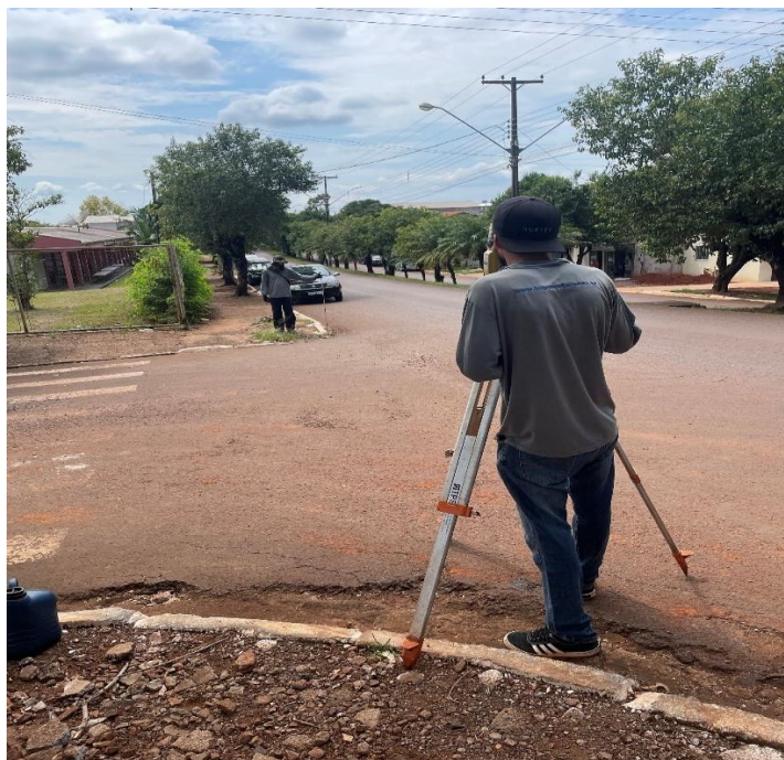
Figura 01: Estação Total operando na data do levantamento
