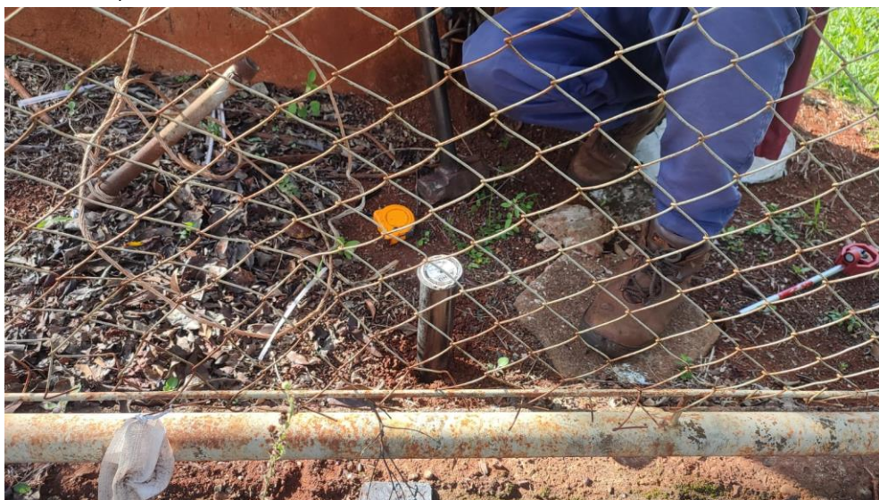
Figura 12: Marco topográfico demarcado referente ao imóvel, Próximo Av. São Paulo
